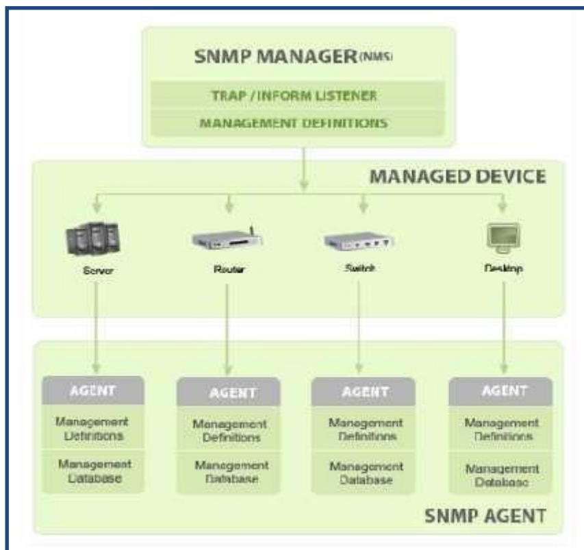
Ilustración 18. Diagrama básico de agente SNMP.
