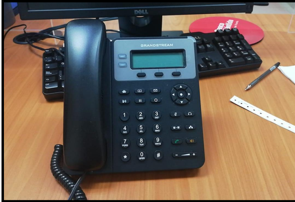
Ilustración 44: Teléfono VoIP modelo GXP1610/1615.
