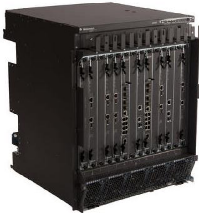
Ilustración 6. Imagen equipo MetaSwitch.
