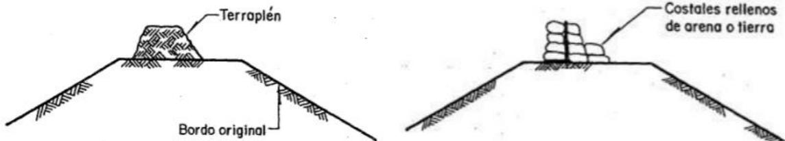
Ilustración 7. Exceso de carga en bordo.), debe realizarse el diseño considerando una carga viva correspondiente al peso del vehículo más grande que puede transitar la zona.
