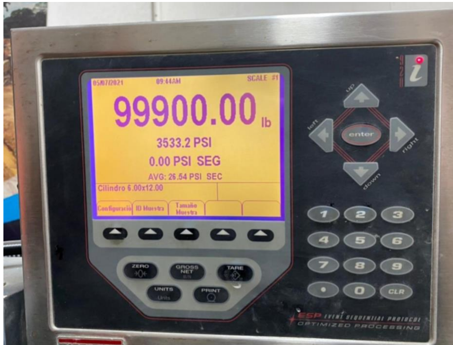
Ilustración 19. -Resistencia obtenida a los 7 días en la fundición de semana 4
