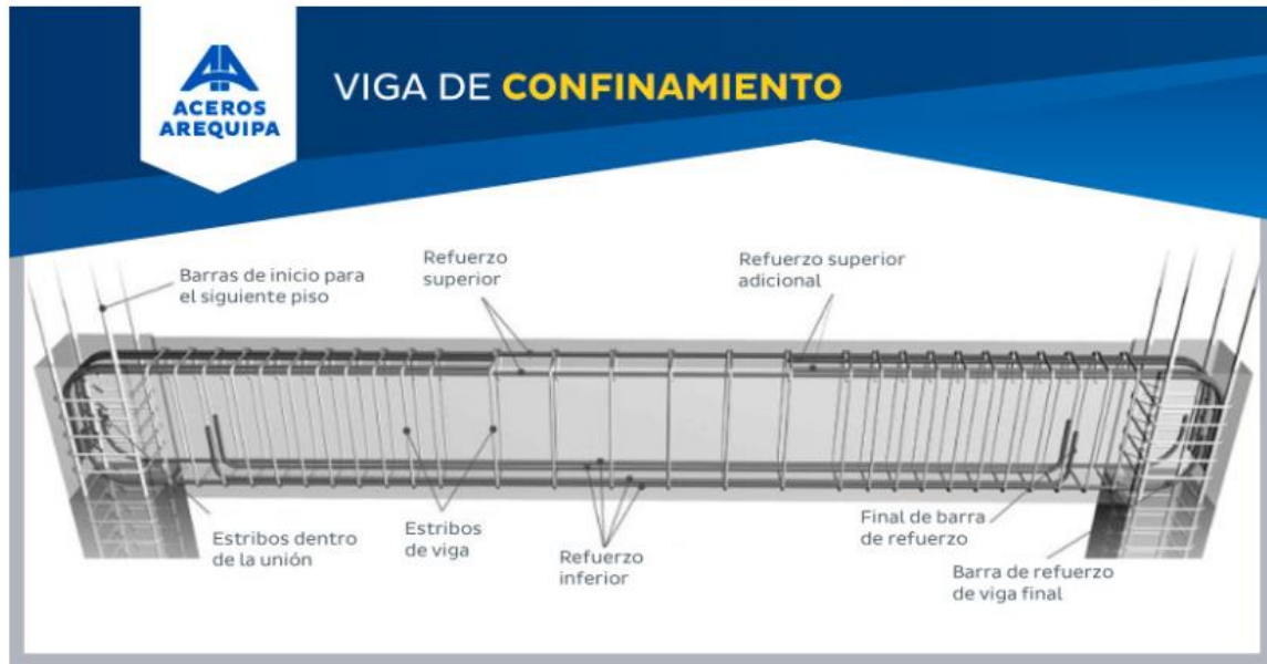
Ilustración 11. -Esqueleto de viga
