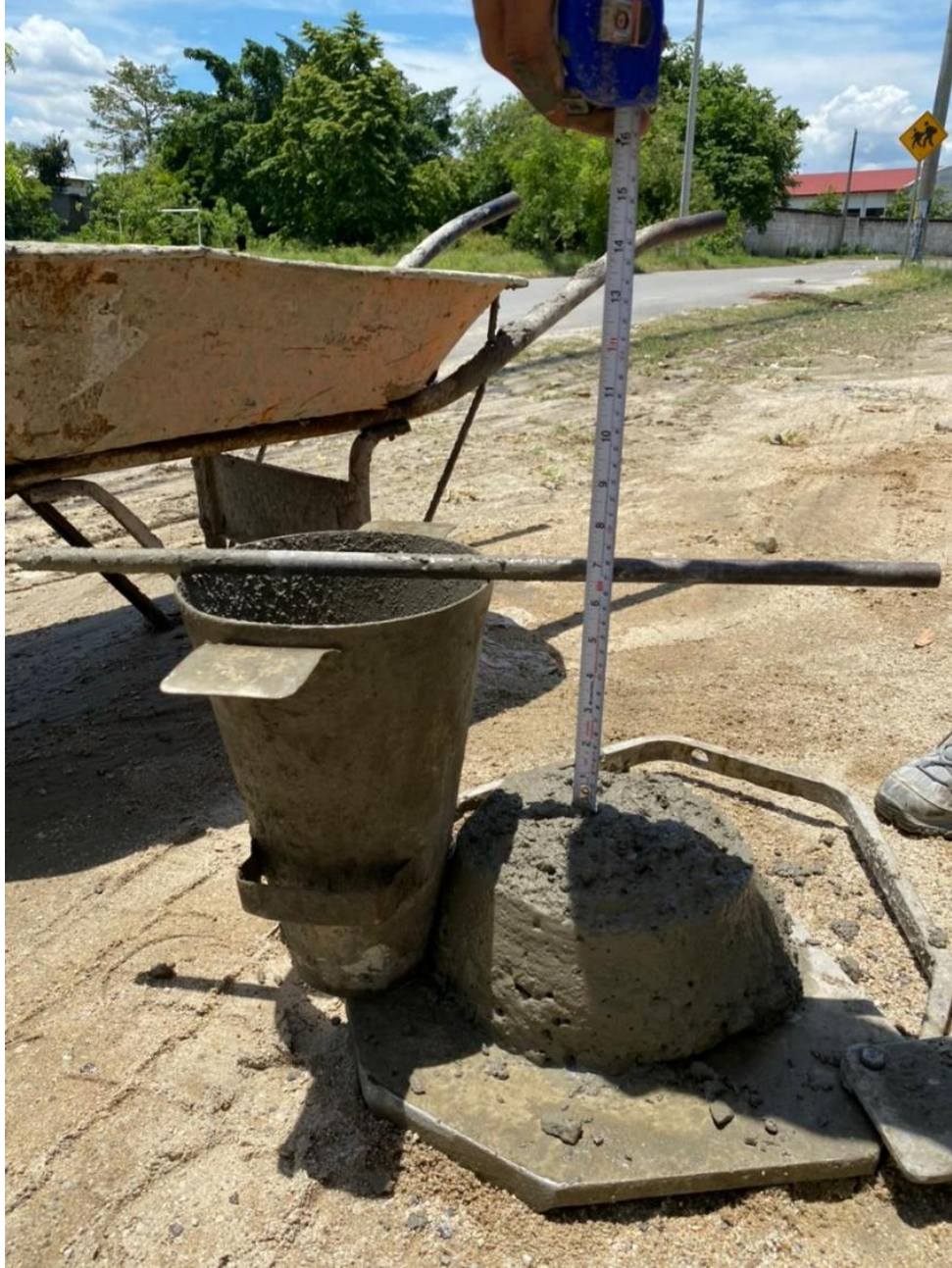
Ilustración 21. -Prueba de Revenimiento del Primer Camión
