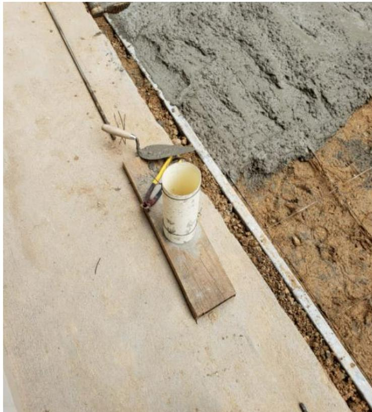
**Ilustración 35-Elaboración de cilindro para prueba de resistencia del concreto hidráulico**
