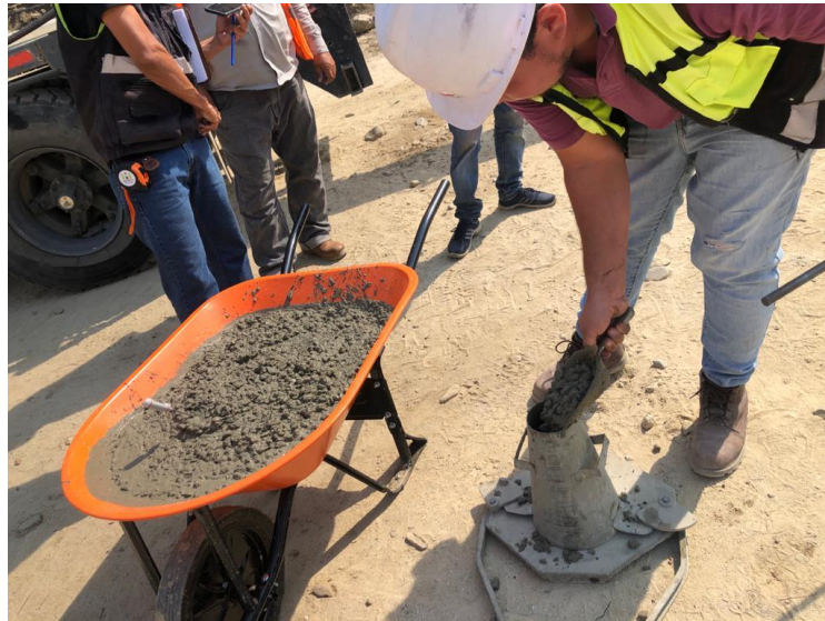
Ilustración 13 – Prueba de Revenimiento (Resultado 6 ½”)
