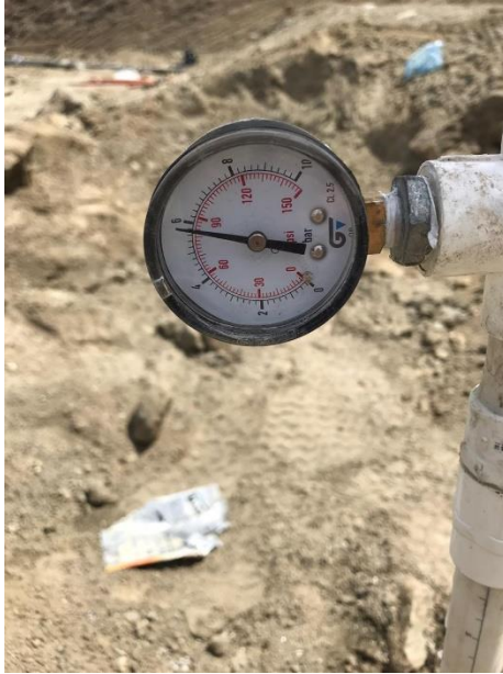
Figura 3: Manómetro utilizado en prueba hidrostática.
