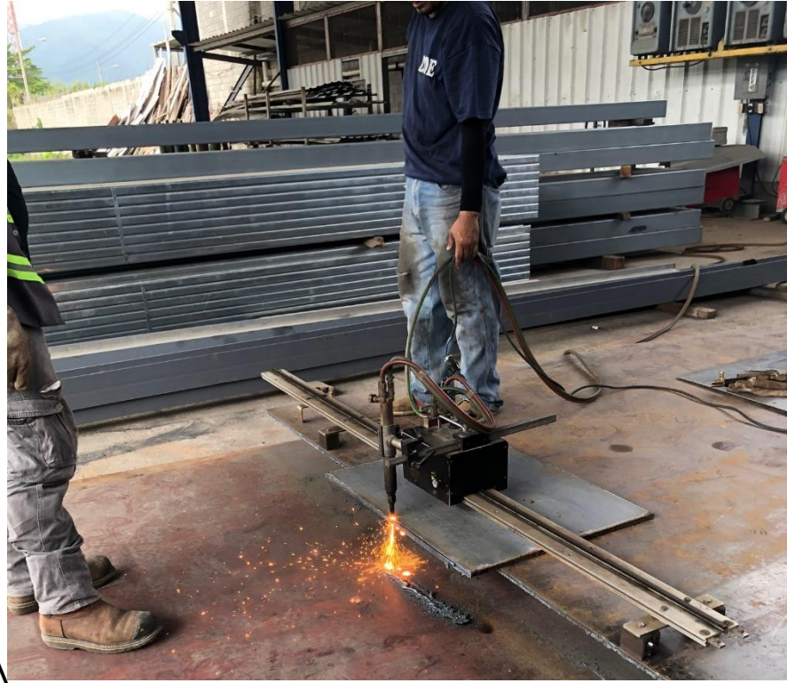
Figura 3. Corte de placas con “la tortiguita”.
