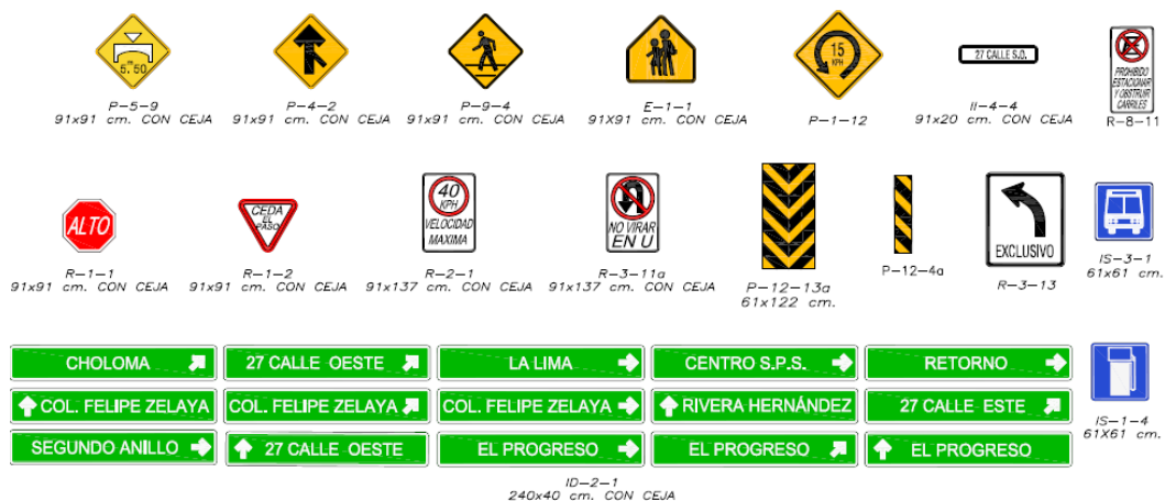
Figura 8. Nueva señalización del Intercambiador de 27 Calle.
