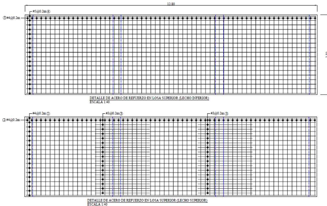
Anexo 34 – Caja Puente Nagarejo: Losa Superior
