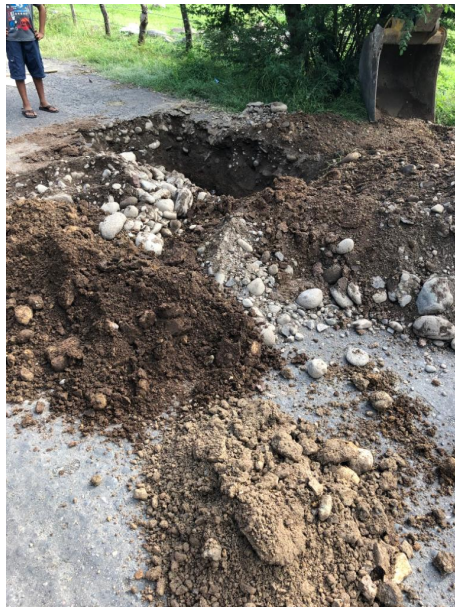
Anexo 8 – Capas divididas y extraídas de calicata
