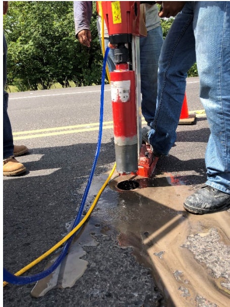
Anexo 15 – Extractor de núcleos de pavimentos flexibles
