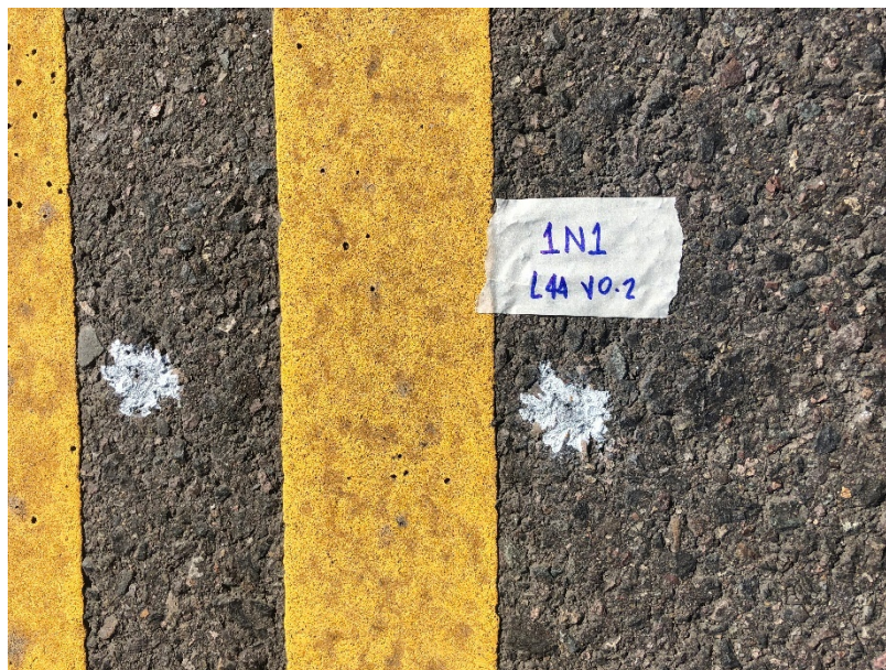
Anexo 14 – Ubicación al azar de núcleos de la primera estación
