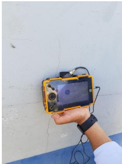
Figura 32. Lectura del aparato convencional de pruebas de ultrasonidos.
