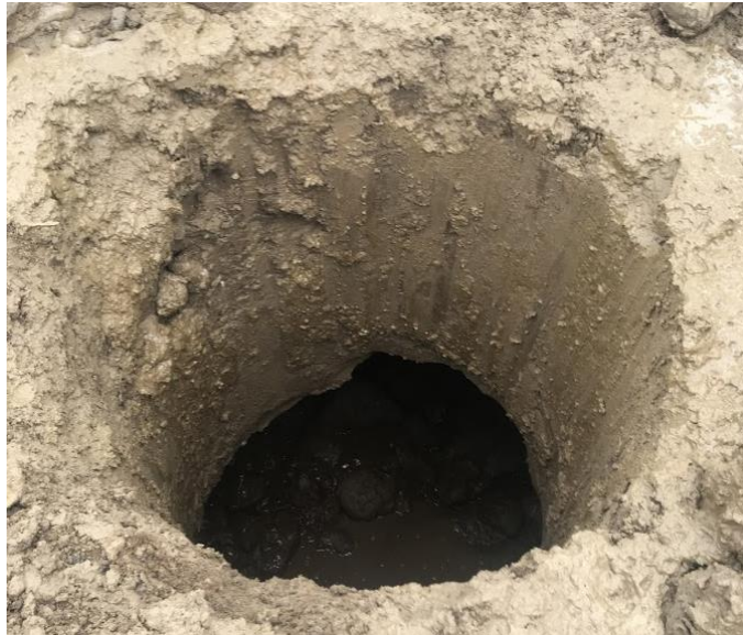
Ilustración 10. Presencia de nivel freático en perforaciones
