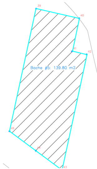
Ilustración 27. Vista en Planta de Bache #5.
