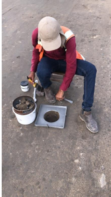
Ilustración 5 Prueba de Densidad In Situ
