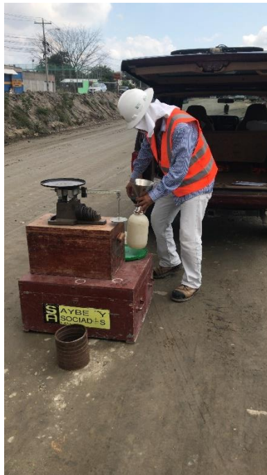
Ilustración 10 Balanza, Arena Calibrada y Cono Invertido para Prueba de Densidad In Situ
