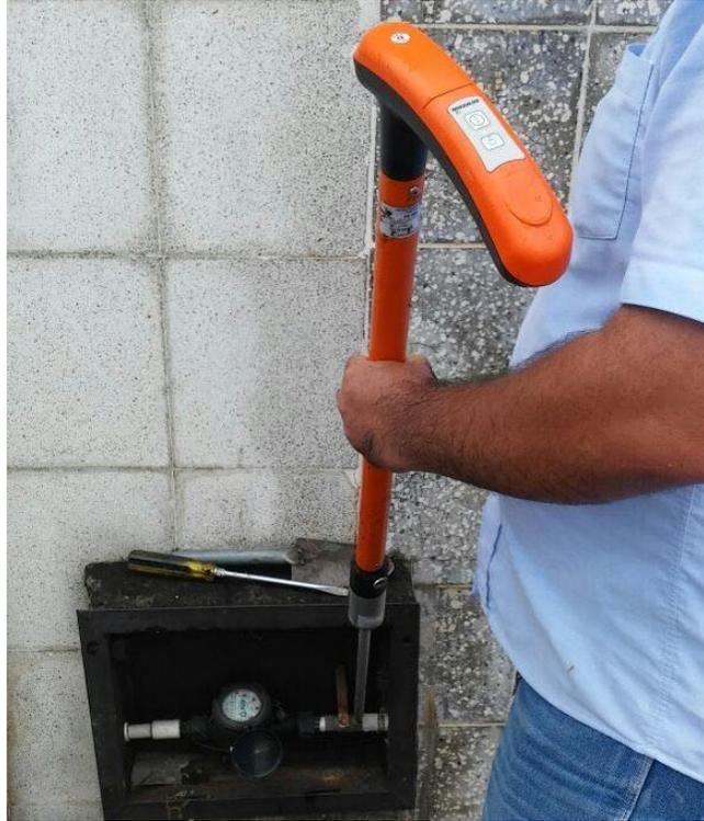
**Ilustración 5.** Colocación de Aquaphon en medidor para detectar fugas.
