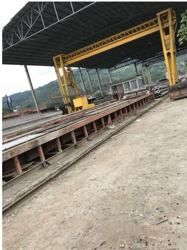
Figura 5. Plantel de Postes Centrifugados.
