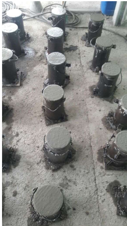
Figura 36. Realización De Cilindros De Concreto Hidráulico.
