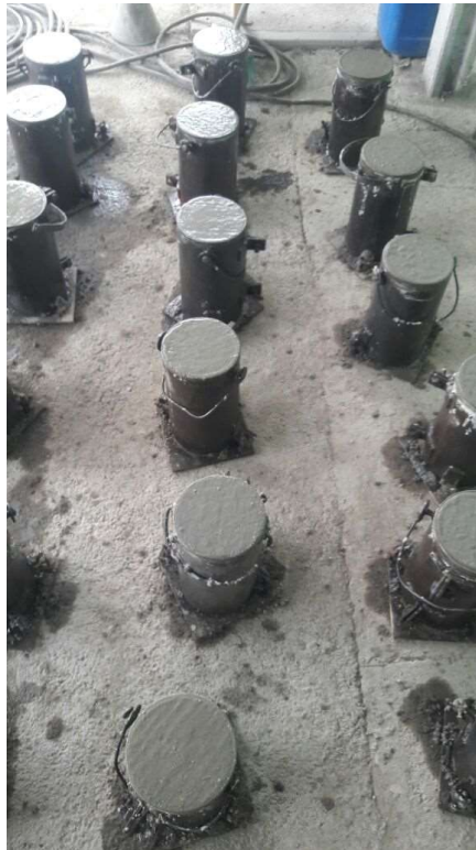
Figura 7. Realización de cilindros para prueba de compresión.
