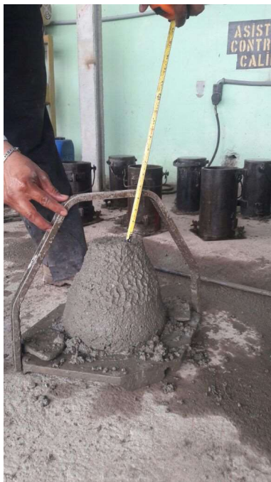
Figura 19. Control De Revenimiento De Concreto Premezclado.
