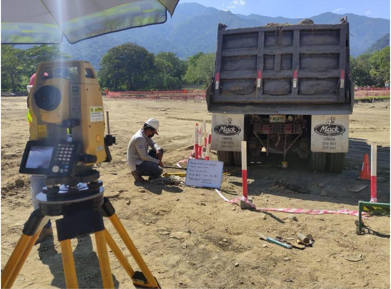
**Ilustración 5:** Modulo de balasto en falla de suelo
