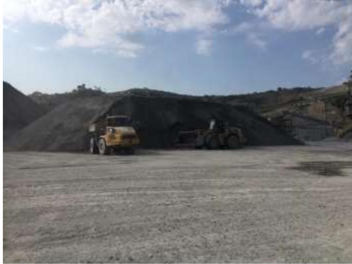
**Figura 9. Camión articulado a espera de ser llenado o ya sea de piedra caliza o tierra**
