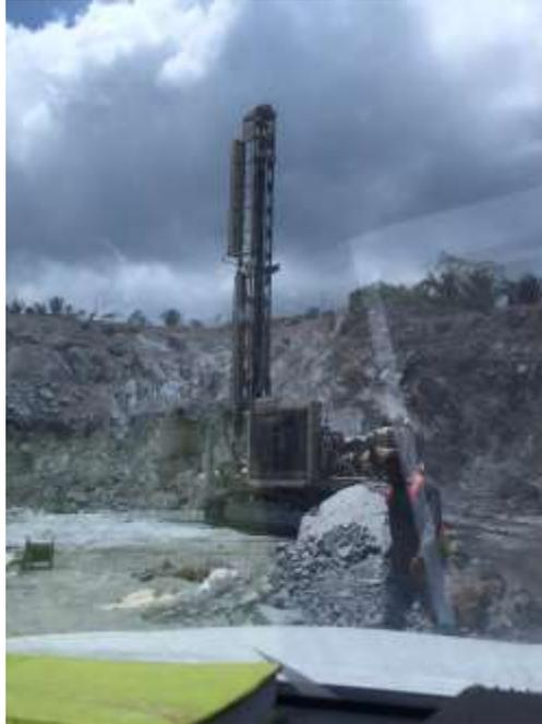
**Figura 3. Drill con las que se hacen las perforaciones para las voladuras.**
