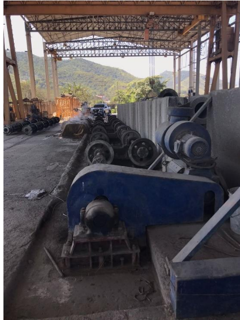
Ilustración 28 - Postes con vapor aplicado y en maquina centrifugadora
