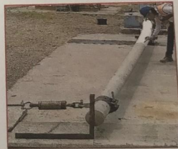
PRUEBA DE FLEXIÓN PARA POSTES
