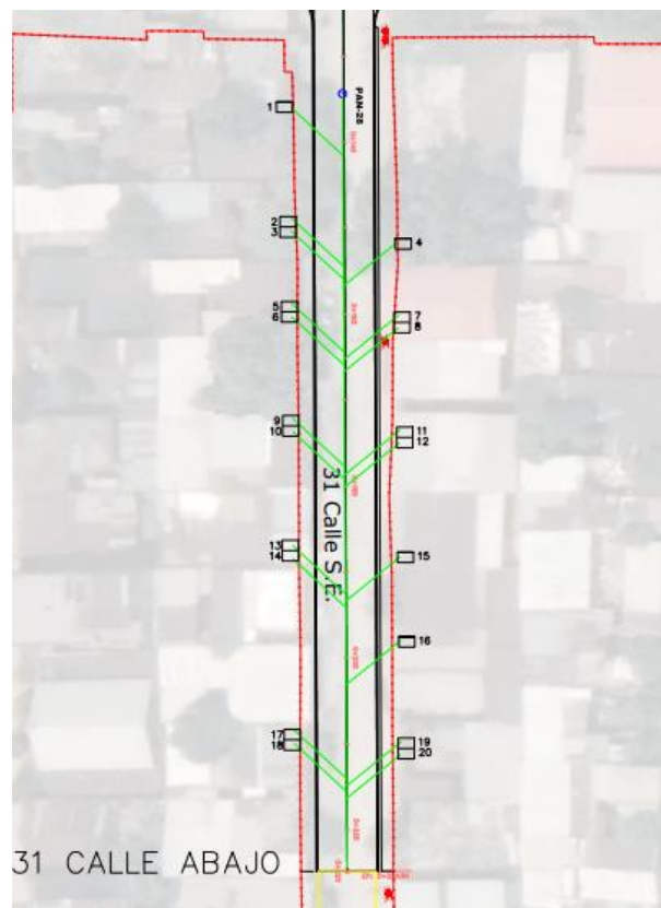
Ilustración 14 - Plano taller, trabajo de tubería
