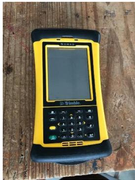
**Ilustración 40. Colectora Trimble nomad 900**
