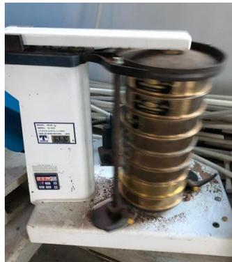
**Ilustración 34. Agitador Mecánico.**
