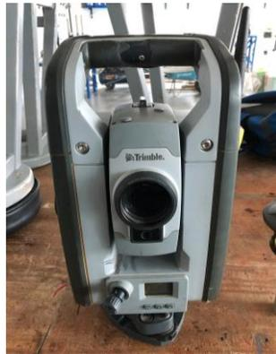
**Ilustración 21. Estación Total Trimble M3**
