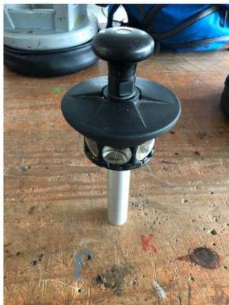
**Ilustración 22. Prisma "Trimble Style RTS/RPT" 360 robótica 2mm.**
