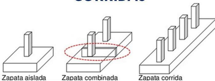
**ZAPATA AISLADA:** Zapata de forma cuadrada o rectangular en la base del pilar, son un tipo de Cimentación Superficial que sirve de base de elementos estructurales puntuales como son los pilares; de modo que esta zapata amplía la superficie de apoyo hasta lograr que el suelo soporte sin problemas la carga que le transmite.
