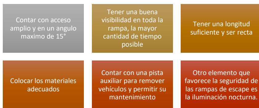
Ilustración 23-Condiciónes mínimas para el diseño de rampas de frenado
