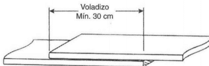
Ilustración 16 Especificaciones de superposición de plancha de andamio.
