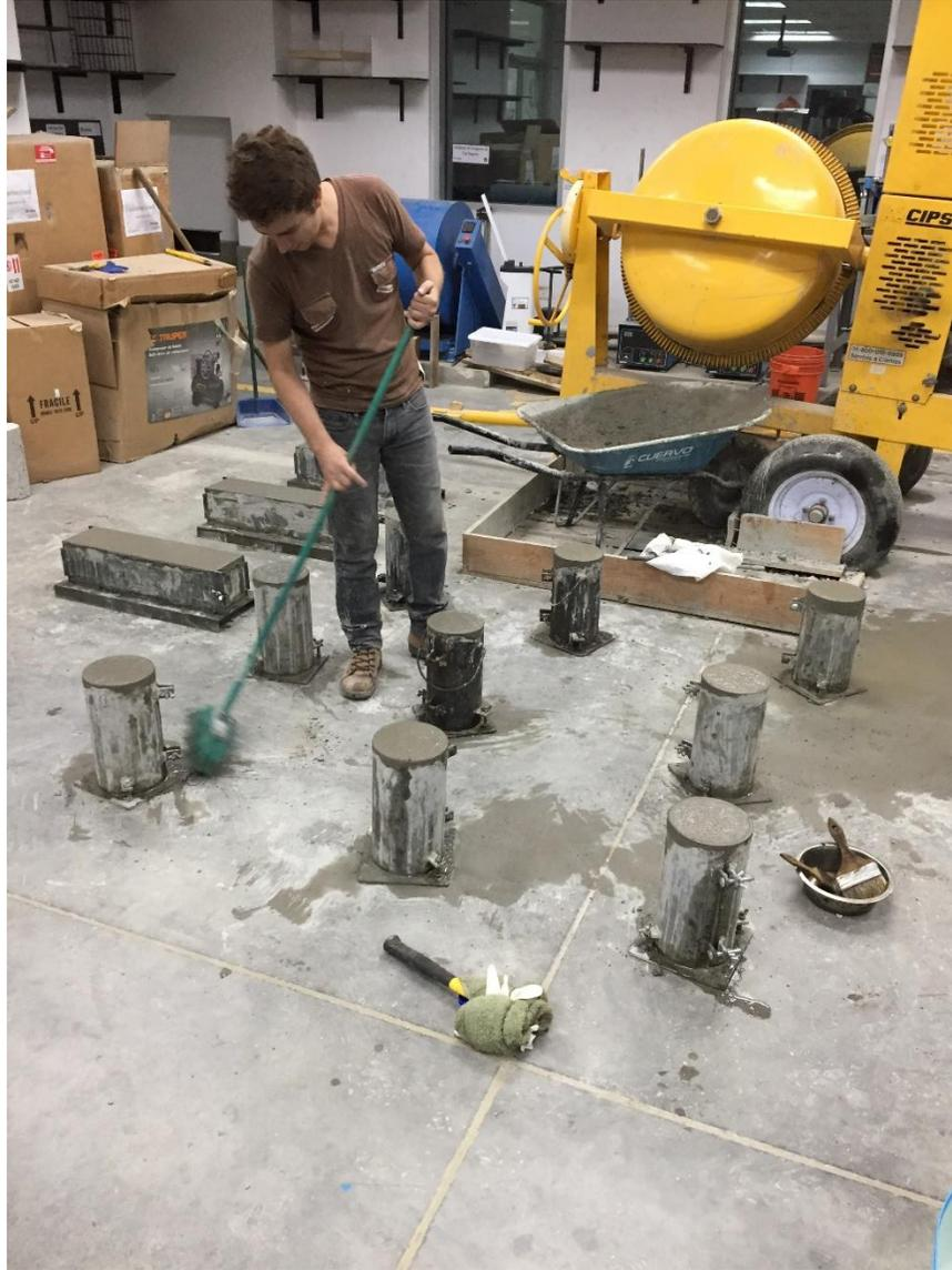
**Ilustración 11. Elaboración de probetas.**
