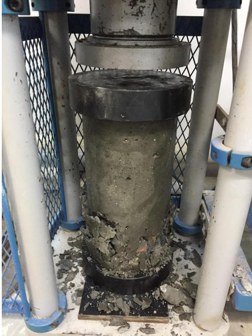
**Ilustración 14. Cilindro sometido en maquina universal de compresión.**
