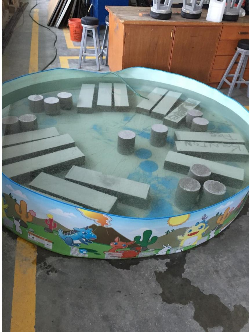
**Ilustración 12. Almacenamiento de vigas y cilindros**
