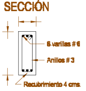
DETALLE DE VIGA V1
