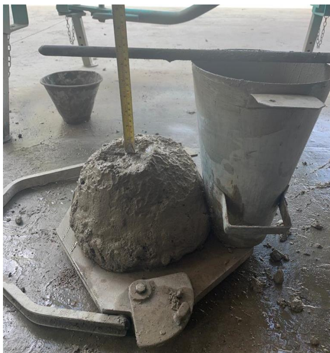
Ilustración 29 – Prueba de revenimiento de la mezcla control
