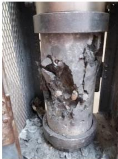
Ilustración 9 - Cilindro a los 28 días con 1.5% de fibra de coco.
