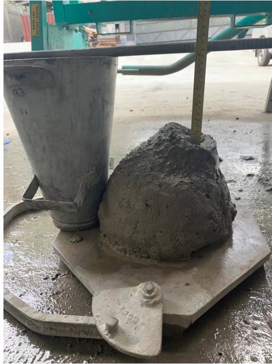
Ilustración 32 – Prueba de revenimiento con 0.9 kg/m 3 FTLR Gruesa
