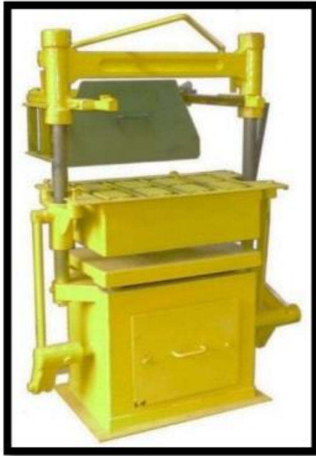
Ilustración 15 - Máquina RosaCometa comúnmente usado para la fabricación semi industrial de Bloques de Concreto
