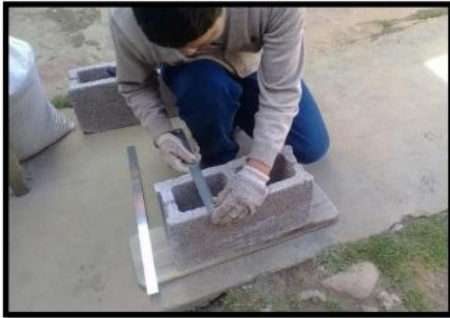
Ilustración 16 - Ensayo de Variación Dimensional en Bloques de Concreto
