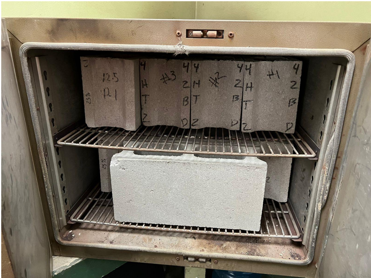
Ilustración 34. Proceso de secado de los bloques al horno
