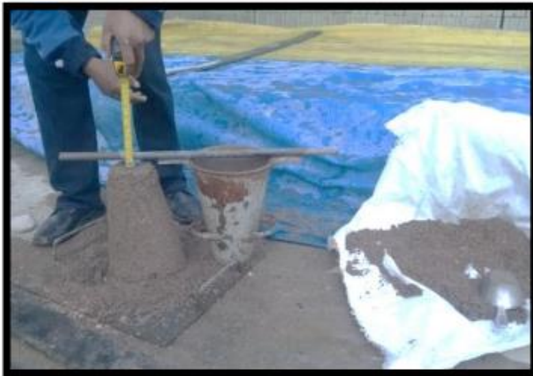
Ilustración 14 - Revenimiento (slump) de la mezcla para Bloques de Concreto.
