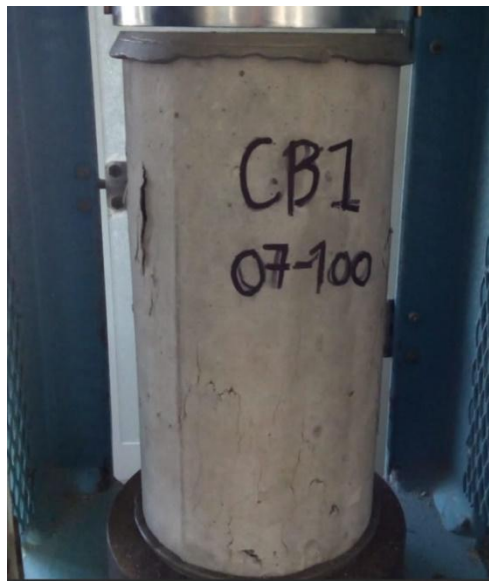
Ilustración 75. Falla por compresión CB107-100
