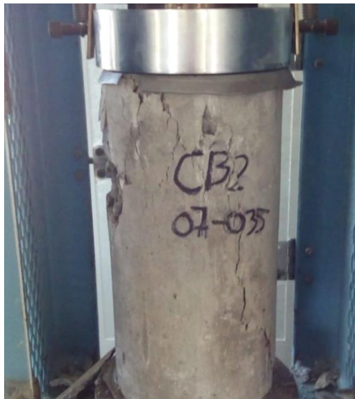
Ilustración 70. Falla por compresión CB207-035
