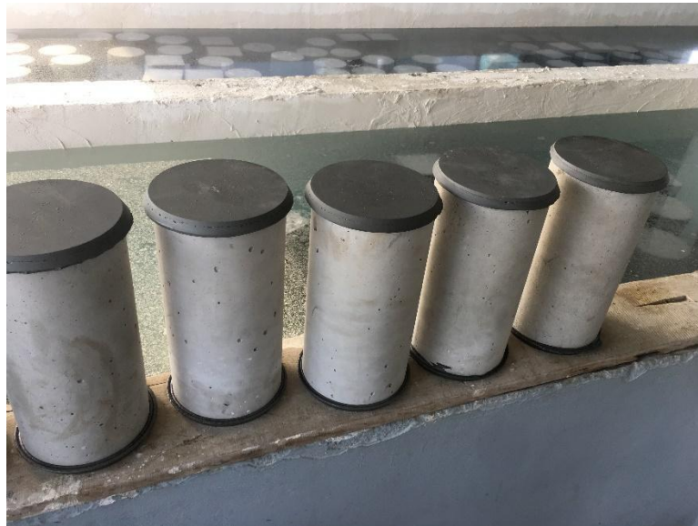
Ilustración 52. Testigos cilíndricos cabeceados
