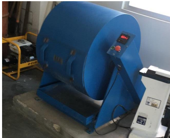
Ilustración 14. Máquina para prueba de Desgaste de los Ángeles
