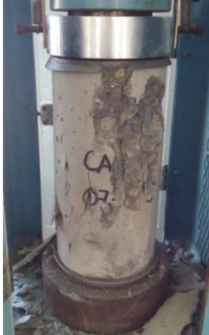
Ilustración 64. Falla a compresión CD207-000
