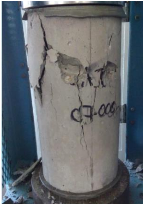
Ilustración 63. Falla a compresión CD107-000
