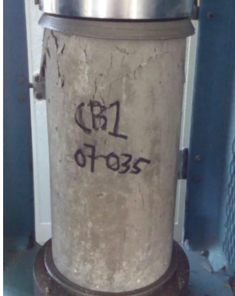
Ilustración 69. Falla por compresión CB107-035
