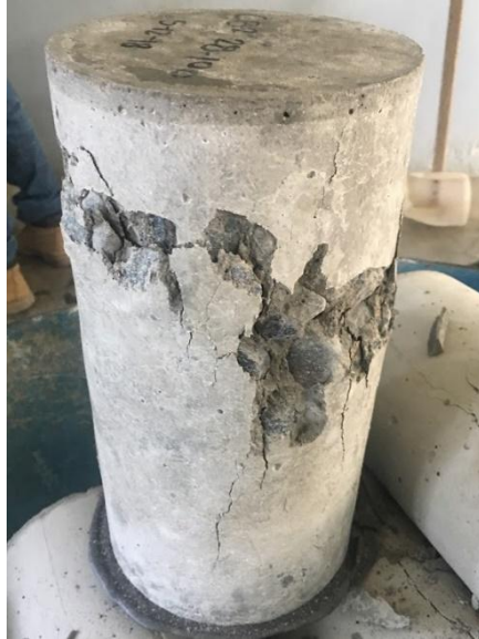
Ilustración 105. Falla por compresión CB128-100
