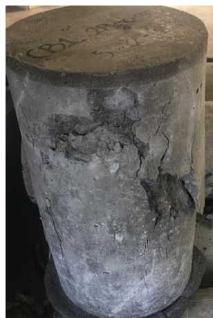
Ilustración 99. Falla por compresión CB128-035
