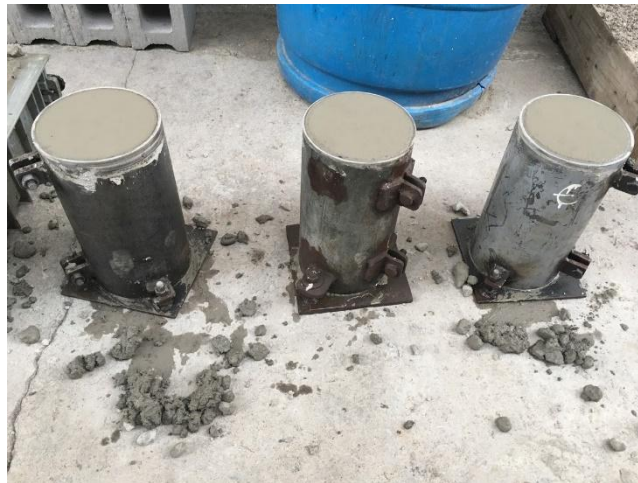
Ilustración 17. Elaboración de probetas cilíndricas
