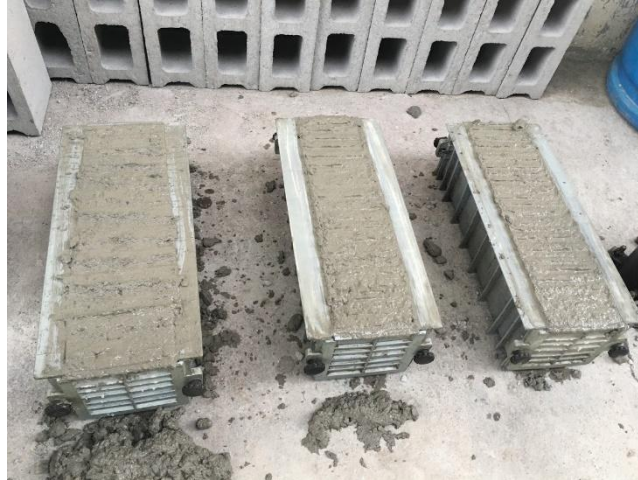
Ilustración 18. Elaboración de probetas prismáticas
