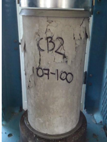
Ilustración 76. Falla por compresión CB207-100
