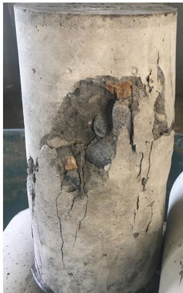
Ilustración 106. Falla por compresión CB228-100
