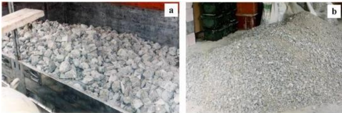
Ilustración 2. Material reciclado antes y después de trituración en Serbia.
