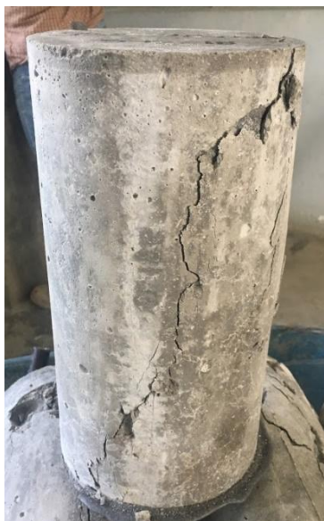
Ilustración 94. Falla a compresión CD228-000
