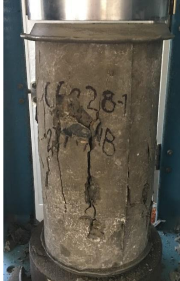
Ilustración 81. Falla por compresión CA128-000
