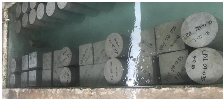
Ilustración 51. Curado de testigos en pilas
