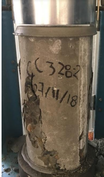
Ilustración 82. Falla a compresión CA228-000
