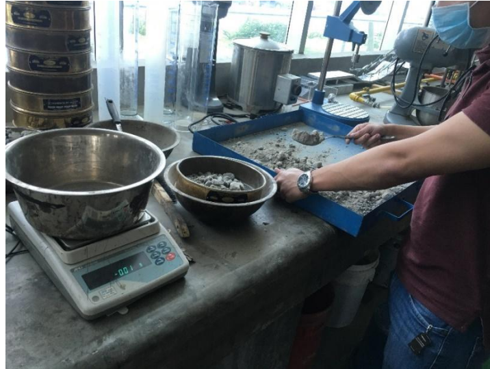
Ilustración 15. Obtención de material en tamiz 12 para desgaste
