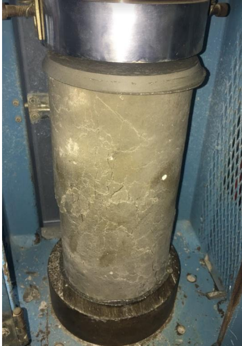
Ilustración 59. Falla a compresión CC107-100
