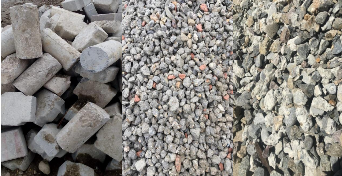
Ilustración 28. Testigos y adoquines de concreto antes y después de trituración
