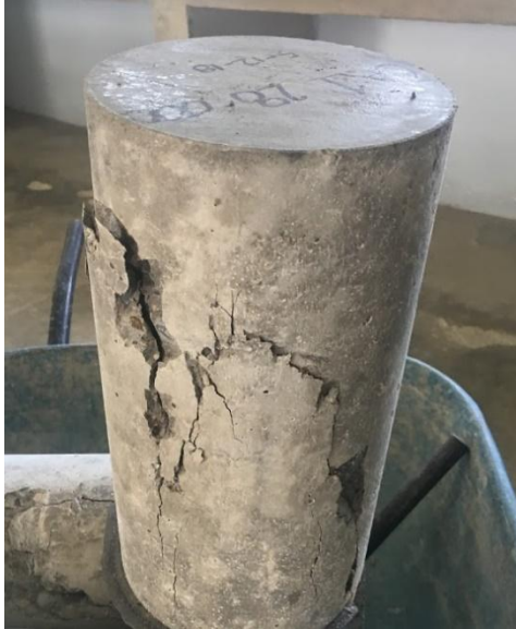
Ilustración 93. Falla por compresión CD128-000
