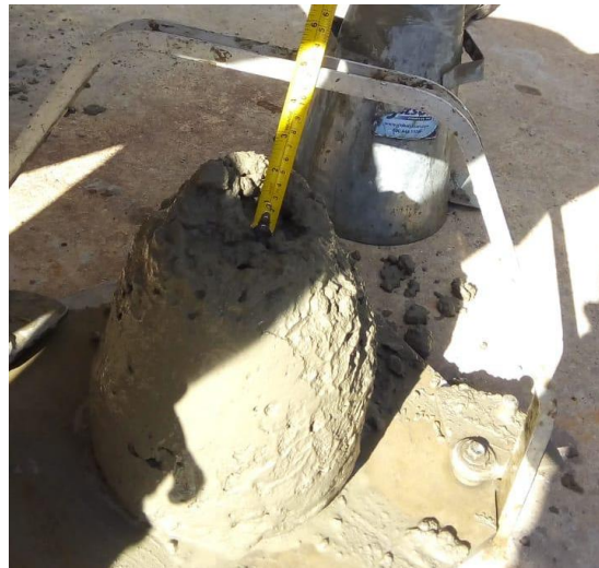
Ilustración 49. Revenimiento de Mezcla 2 con sustitución de 35%
