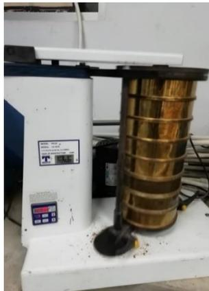
**Ilustración 23- Tamizador mecánico**
