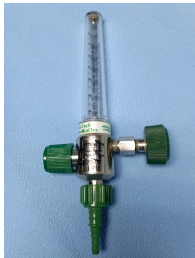
Ilustración 46: caudalímetro de oxígeno
