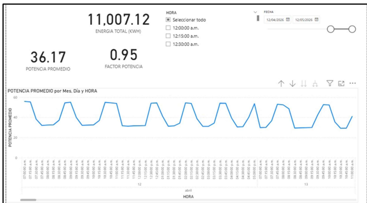
Figura 9: Potencia y energía Mes de Abril en horario 7:00AM a 5:00PM
