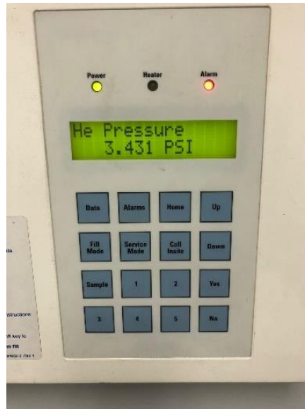
Ilustración 7 Medición de presión de Helio en una RM
