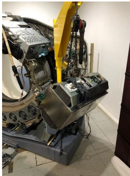
Ilustración 8 Cambio de aceite anti conductivo de una TAC
