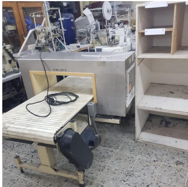
Ilustración 13. Detectora de metal en zona de parqueo.
