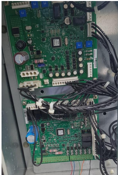
Ilustración 16. Placa nueva integrada al aire central.
