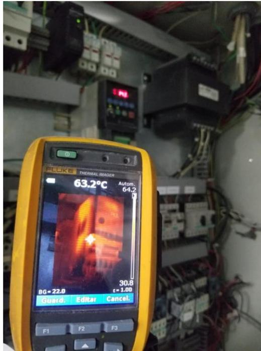
Ilustración 14-Medición de temperatura de paneles eléctricos
