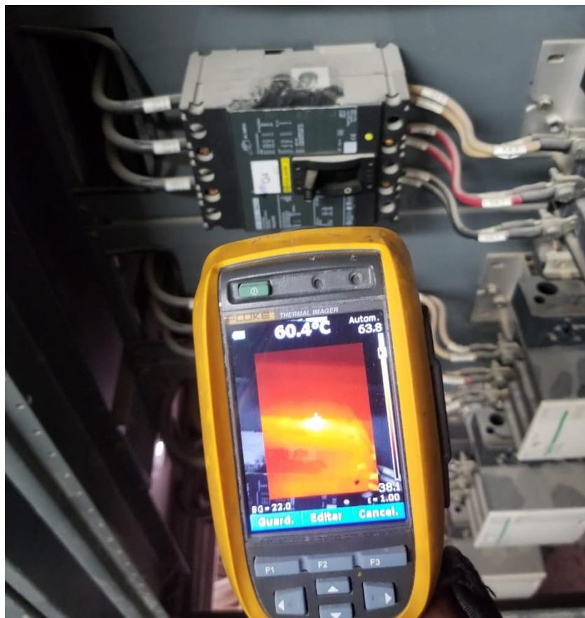
Ilustración 8-Medición de temperatura del panel de control
