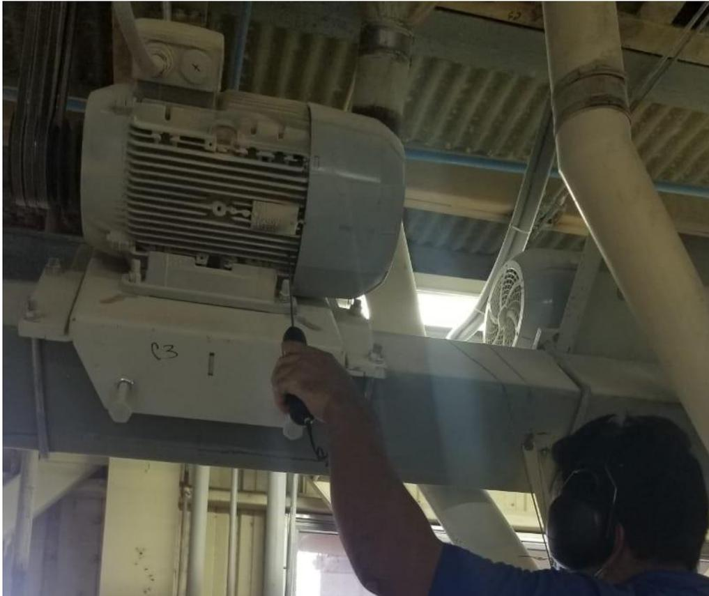
Ilustración 9-Análisis de ultrasonido de los motores
