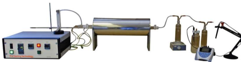
Ilustración 18. Equipo de pruebas corrosivas en cables eléctricos
