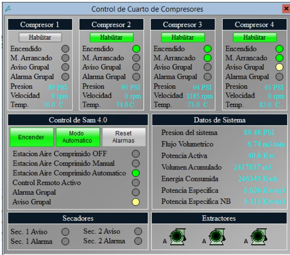
**ILUSTRACIÓN 31. SCREEN CUARTO DE COMPRESORES**
