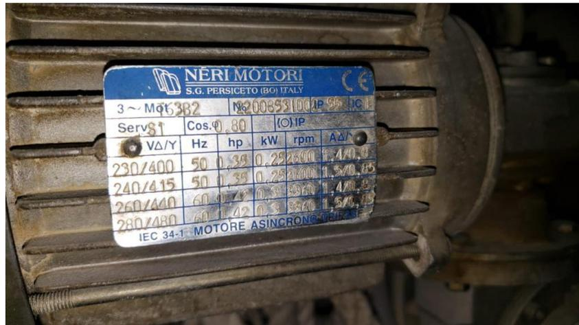
**ILUSTRACIÓN 24. MOTOR ASINCRONO TRIFASICO GABINETE DOSIFICADOR**
