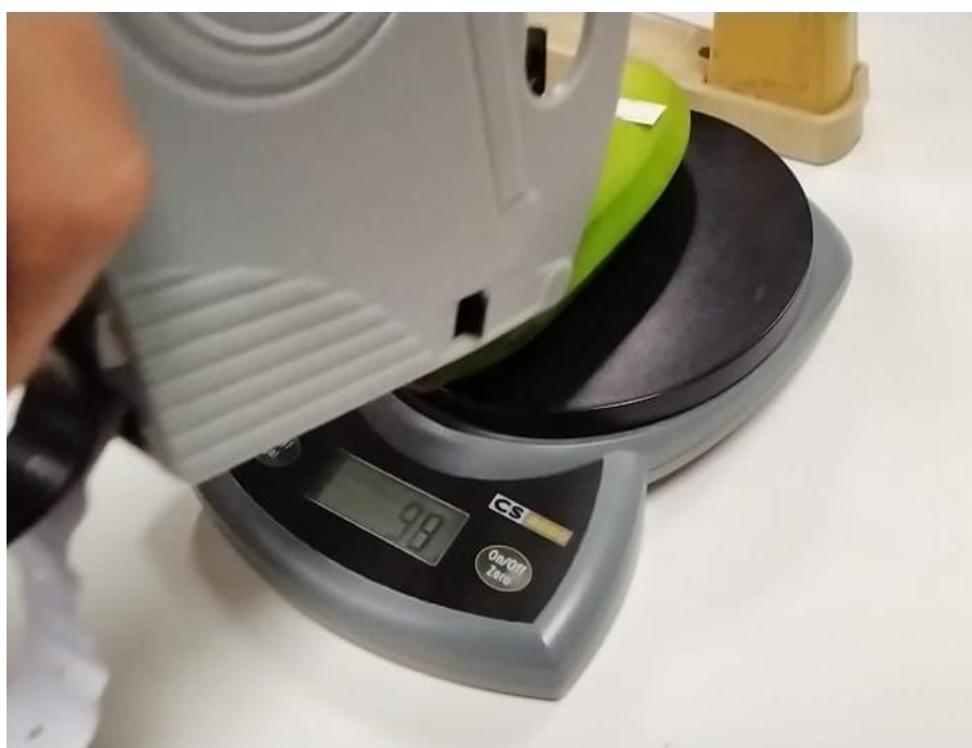
Ilustración 48 – Ensayo de cálculo de fuerza promedio de etiquetado
