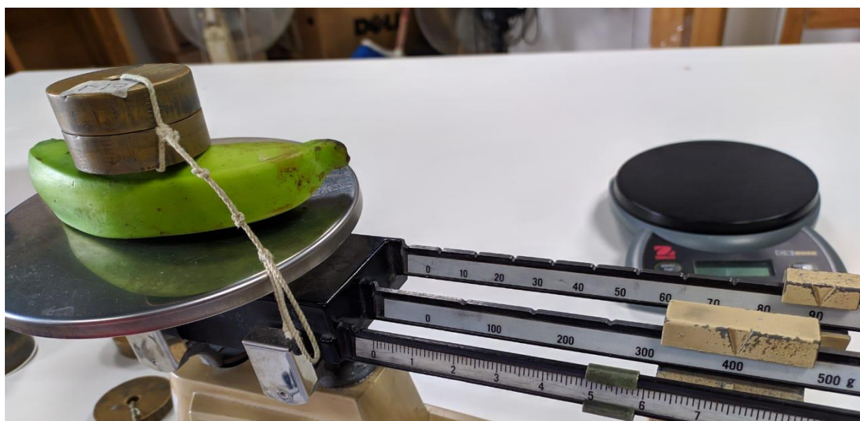
Ilustración 45 – Prueba con masa de 200g
