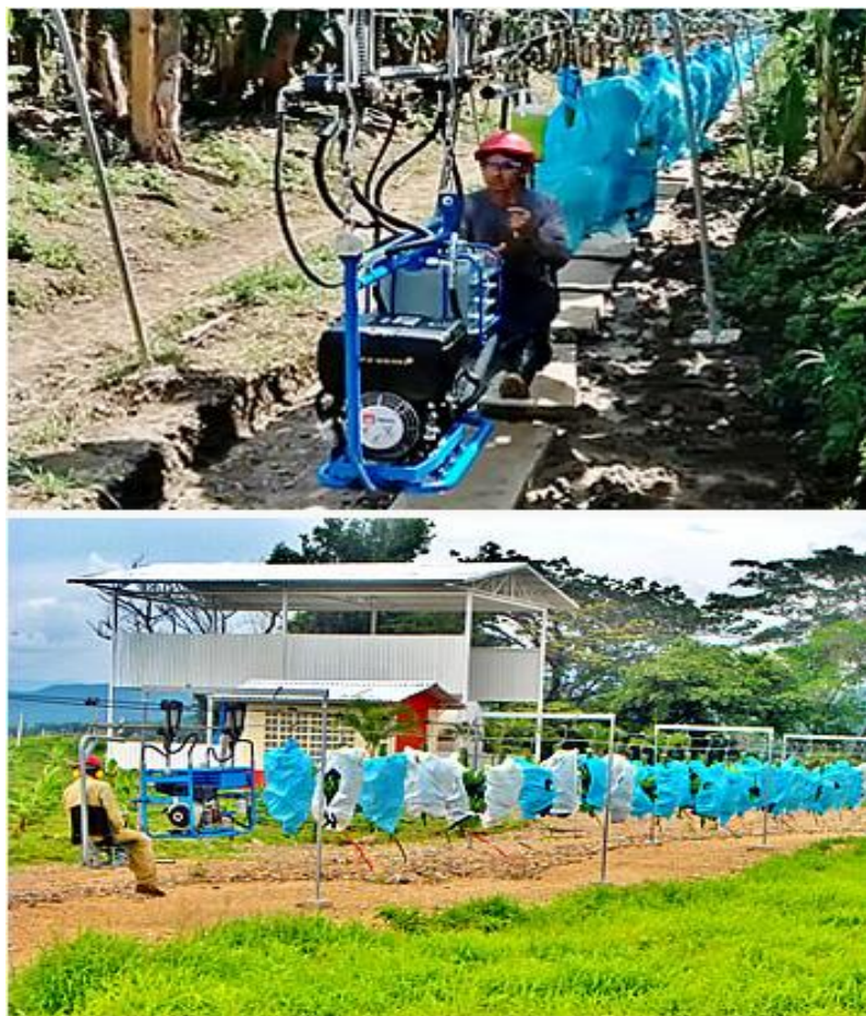
Ilustración 14 – Cable Vías para transporte de bananos
