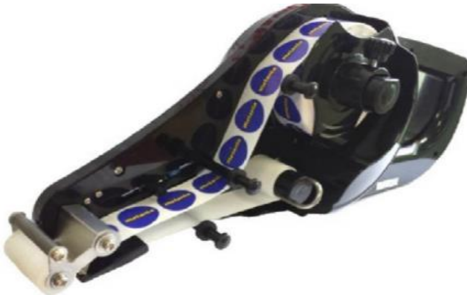
Ilustración 2 – Aplicadora manual para frutas APLIFRU
