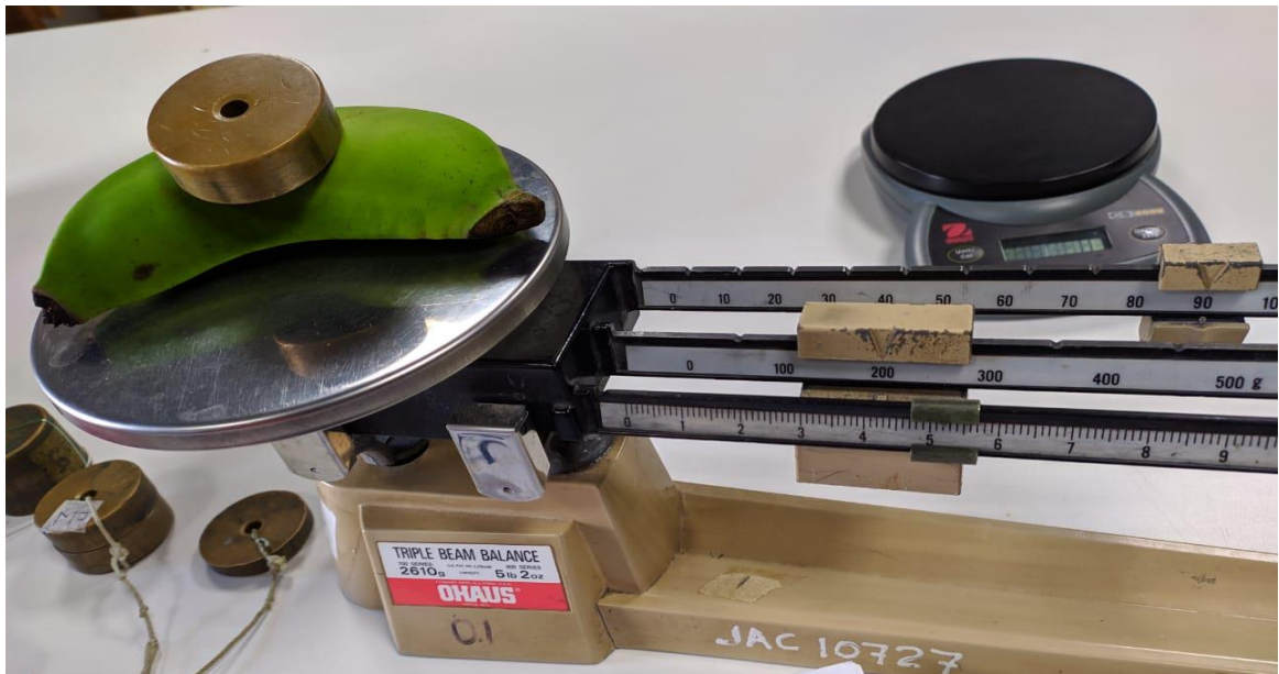
Ilustración 46 – Prueba con masa de 100g
