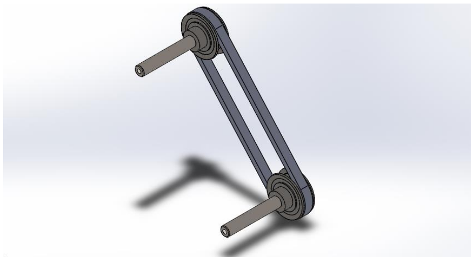
Ilustración 35 – Montaje de polea y banda
