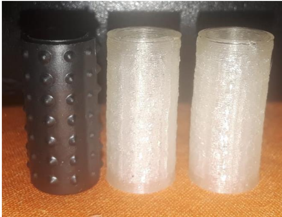
Ilustración 29 – Impresión 3D con superficie lisa del rodillo original
