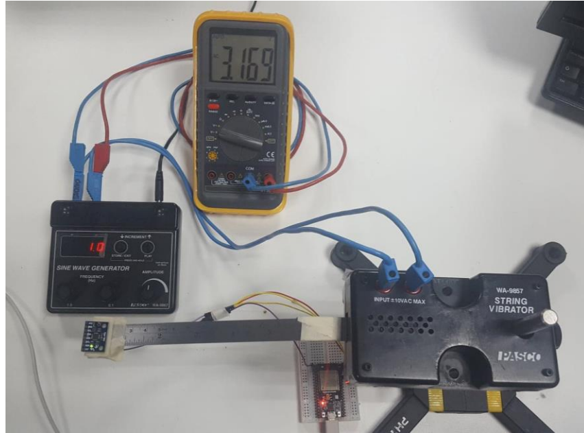
Ilustración 34. Pruebas de Cantilever para 1Hz
