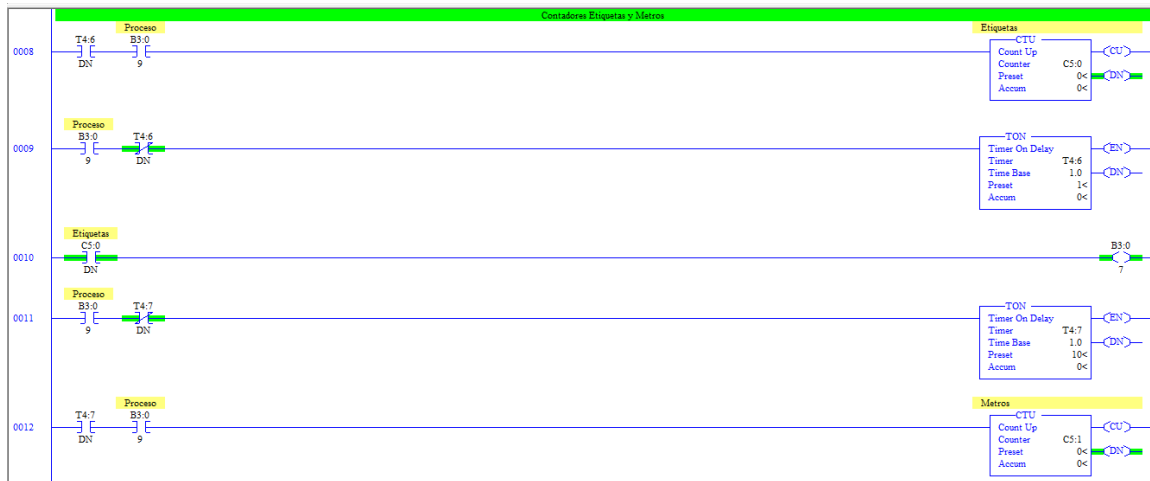
Ilustración15. Programación en RSLogix500 para Allen Bradley.
