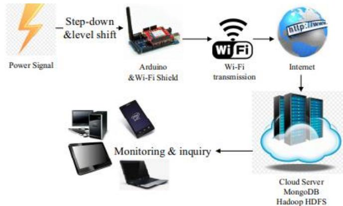
**Ilustración 6 Diagrama del sistema del dispositivo móvil para el monitor de señal de potencia.**
