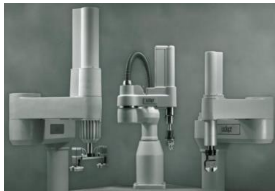
Ilustración 17-Primer robot SCARA con accionamiento directo: AdeptOne
