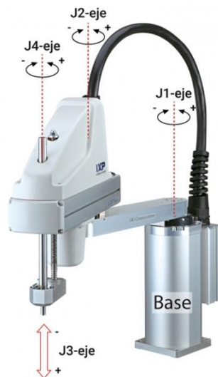
Ilustración 18-Configuración mecánica tradicional de un robot SCARA
