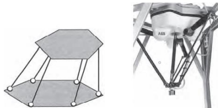
Ilustración 12-Configuración mecánica y ejemplo de un robot paralelo
