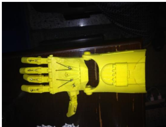
Ilustración 31-Mano protésica Raptor Hand elaborada utilizando impresión 3d
