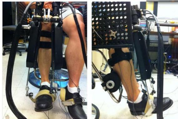
**Ilustración 17. Rehabilitador de tobillo ANKLEBOT**
