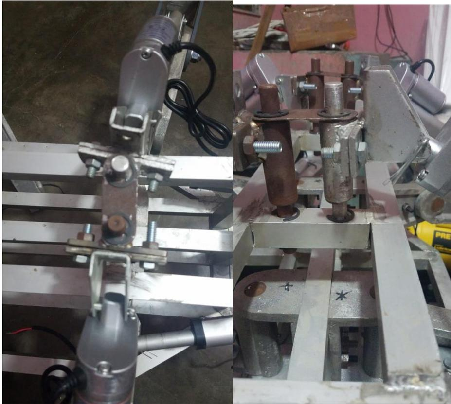
*Figura 30 mecanismo de soporte giratorio*
