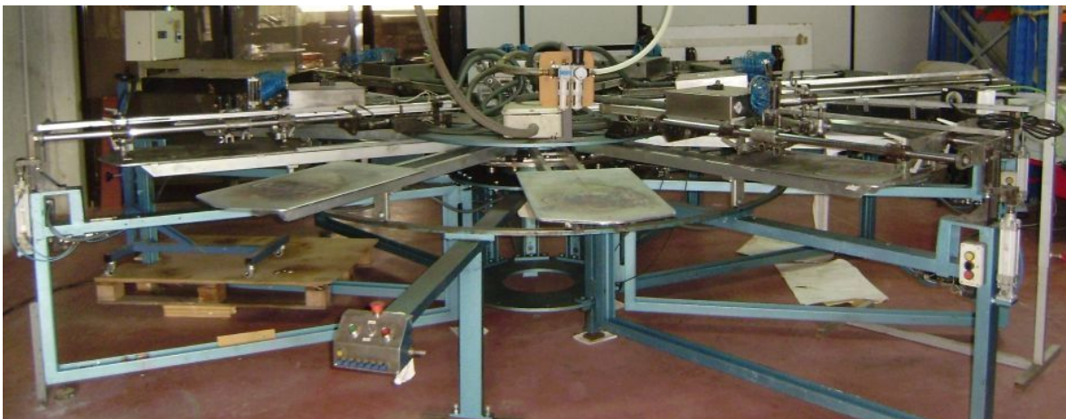
Ilustración 24: Máquina de estampación Sambria, tipo carrusel de 7 colores
