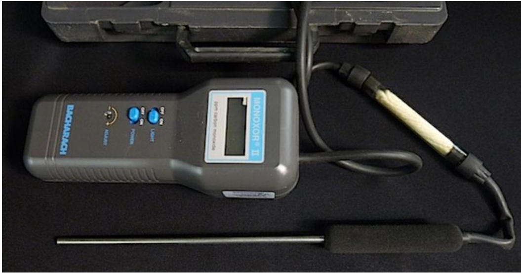
Figura 15. Analizador de monóxido de carbono.
