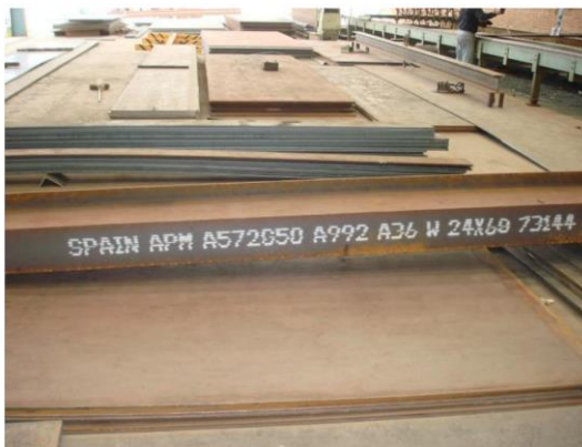
Figura 3. Perfil laminado de acero, según norma ASTM
