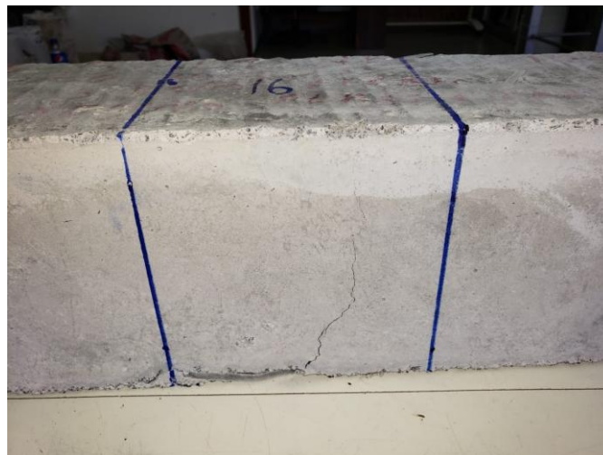
Figura 12. Falla Dúctil en la Vigueta Experimental, Luego de la Aplicación de la Carga Máxima (P) en la Máquina de Ensayos a Flexión, Elaborada con una Dosificación con la
