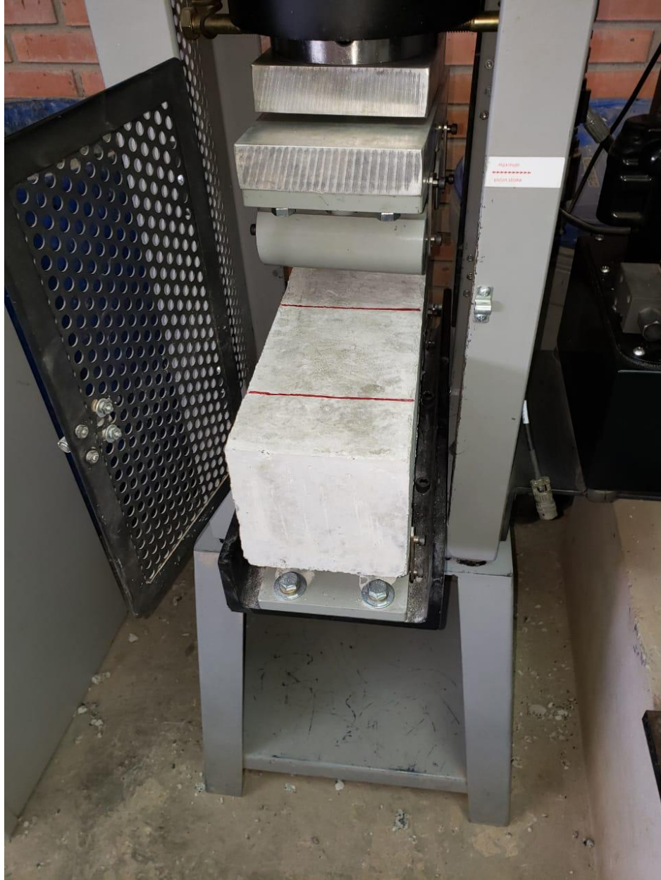
Figura 10. Máquina de Ensayos, Adaptada para Realizar Ensayo a Flexión de una Vigüeta Experimental.
