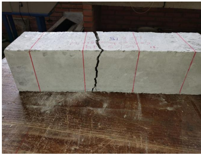
Figura 11. Falla Frágil en la Vigueta Experimental, Luego de la Aplicación de la Carga Máxima (P) en la Máquina de Ensayos a Flexión, Elaborada con la Dosificación de Control.
