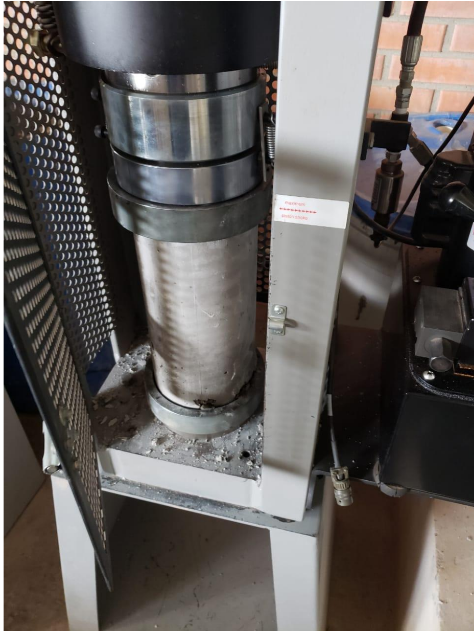
Figura 9. Máquina de Ensayos, Adaptada para Realizar Ensayo a Compresión de un Cilindro Experimental.
