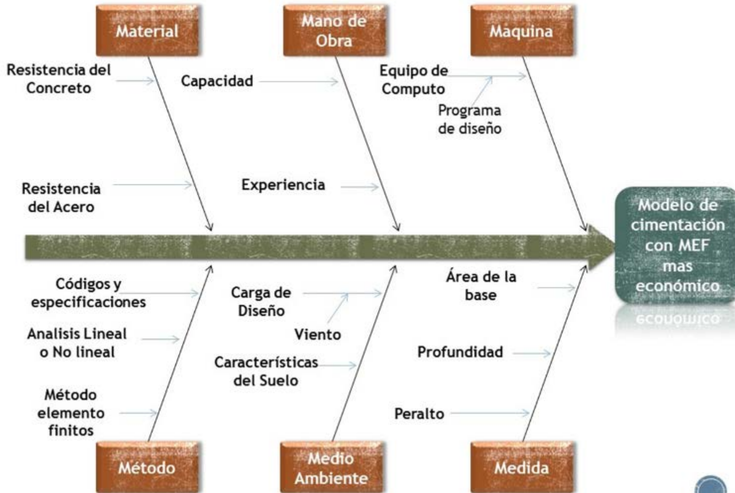
Figura 54. Diagrama Causa y Efecto, proyecto de investigación Racionalización d cimentaciones para torres de telefonía móvil
