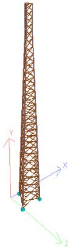
Figura 24. Modelo en Staad.PRO torre AJ Ingenieros 60mts 90MPH
