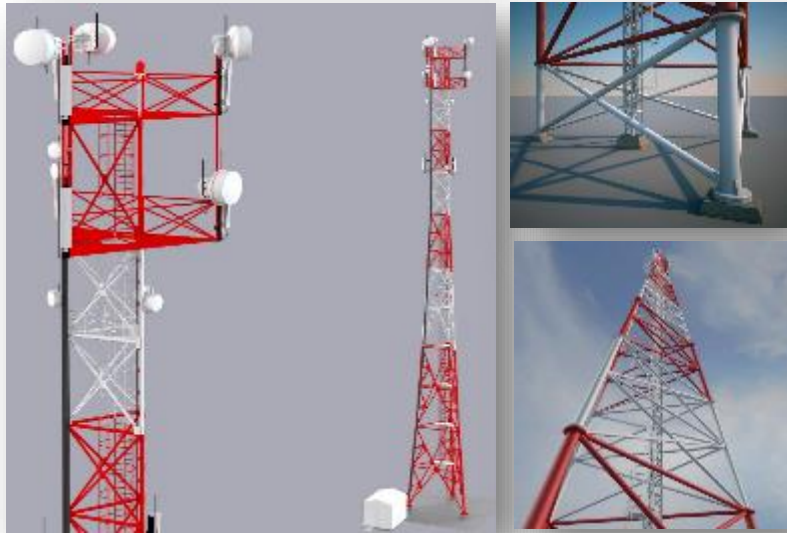
Figura 7. Torre autoportada triangular
